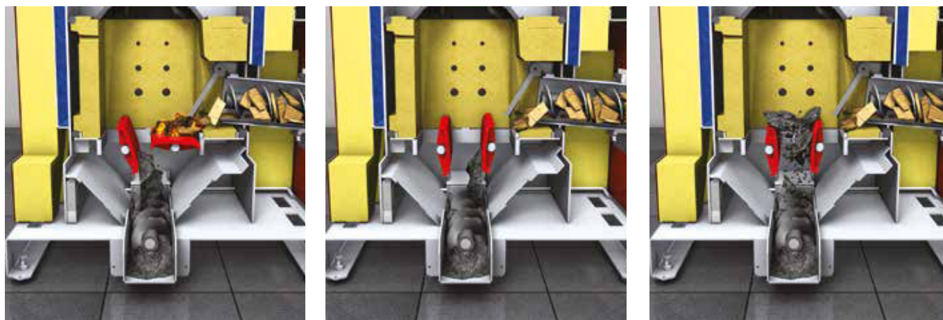
Figura 1 – Schema di funzionamento della griglia «double rotary»
