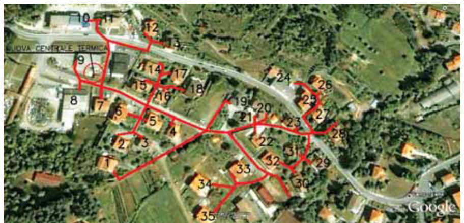
Vista aerea del percorso della rete di teleriscaldamento dalla centrale termica installata da Herz alle abitazioni di Camporgiano
